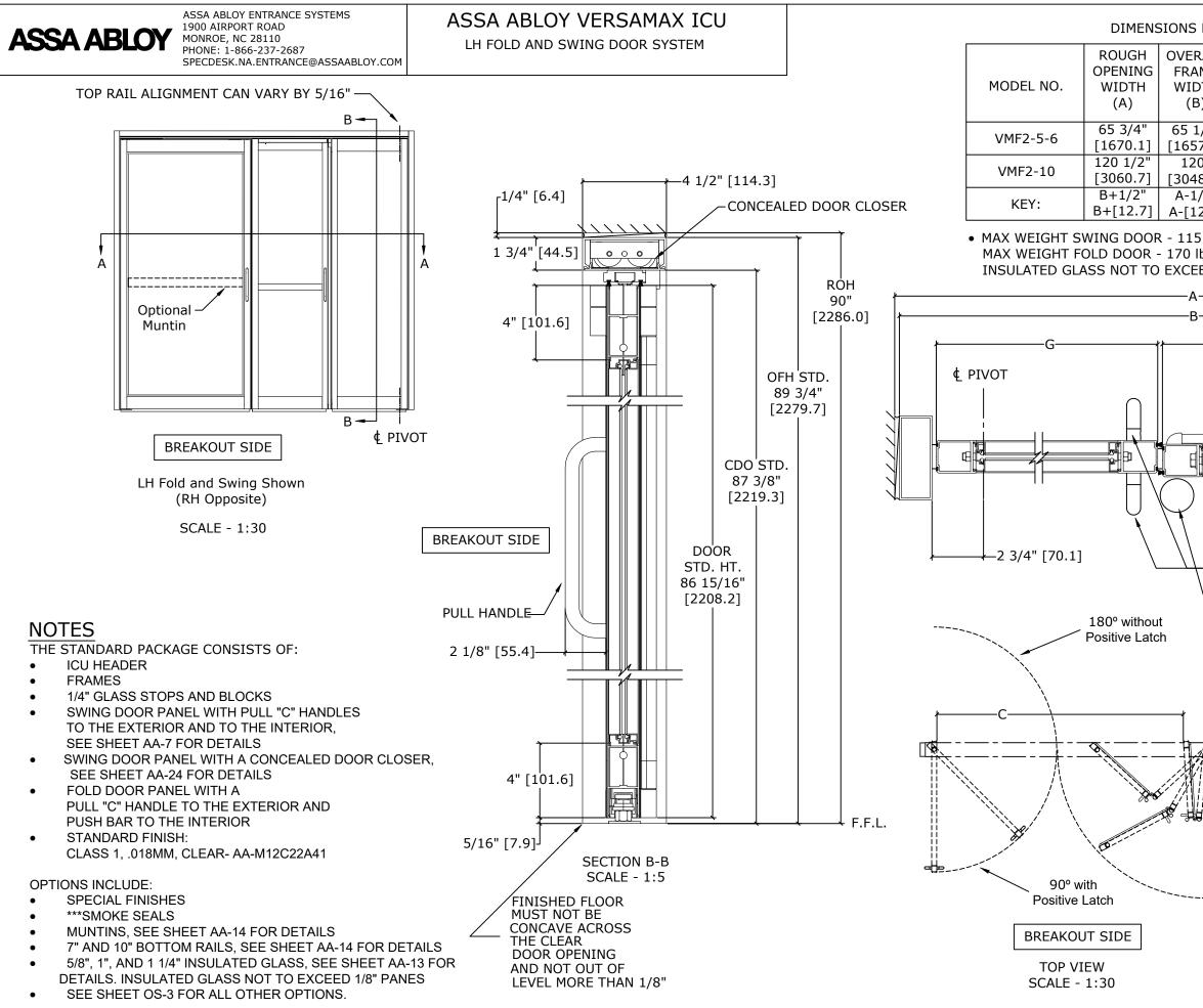
\*\*\* SMOKE SEAL PACKAGE IS DESIGNED TO MEET THE SMOKE INFILTRATION ASPECTS OF UL1784.
