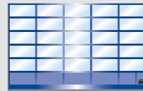
Rambyggd port med bottensektion med plana fyllningar.
