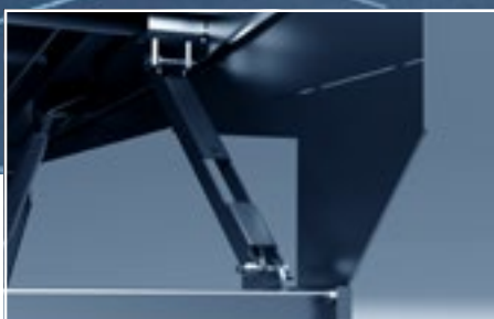
4. Samopoložovacie bezpečnostné zábrany zlepšujú bezpečnosť prevádzky aj údržby a vie ich umiestniť jedna osoba v dvoch jednoduchých krokoch
