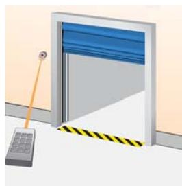
Un radiocomando consente di azionare il portone da un veicolo o da qualsiasi posizione entro una distanza di 50-100 metri dal ricevitore e dall'antenna installata vicino al portone. Per la chiusura, il portone può essere dotato di fascio di fotocellule. Ricevitore installato nel quadro elettrico, antenna installata sulla parete a fianco del portone.
