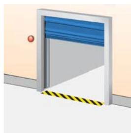
Una o due luci di sicurezza indicano che il portone è in movimento o chiuso; luce continua quando il portone è chiuso, luce lampeggiante quando il portone è in movimento o non completamente aperto.
