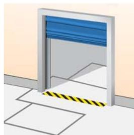
Un sensore nel pavimento rileva la presenza di un oggetto metallico (solitamente carrelli elevatori o transpallet) e apre automaticamente il portone. Questa è un'ottima soluzione in presenza di traffico veicolare intenso. Installata nel pavimento all'esterno, all'interno o da entrambi i lati del portone.
