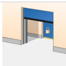
Progettato per il controllo della temperatura o sicurezza; se il portone A è aperto, non può essere aperto il portone B. Se il portone B è aperto, non può essere aperto il portone A. Un portone con interblocco può memorizzare un comando di apertura, se selezionato tramite microinterruttore. È possibile installare come accessorio opzionale un interruttore di bloccaggio esterno per la disattivazione.
