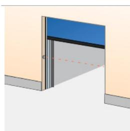
Una serie di trasmettitori e ricevitori a fotocellule è installata nell'apertura del portone. Se il fascio delle fotocellule viene interrotto durante la chiusura, il portone si arresta in meno di 30 mm e inverte il movimento riaprendosi completamente. Installato nell'apertura del portone a 300 mm dal livello del pavimento.
