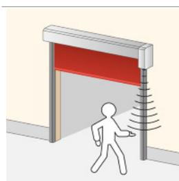
È possibile installare un sensore a infrarossi per consentire l'apertura senza contatto per il passaggio delle persone. Il sensore può essere collocato nel carter del motore oppure è possibile utilizzare un supporto alternativo per installare il dispositivo in qualsiasi posizione. Si tratta di una soluzione ideale in un ambiente in cui, per motivi igienici, si deve evitare di toccare gli oggetti.
