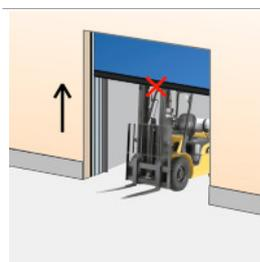
Tutte le porte sono equipaggiate con un rilevatore. Il rilevatore wireless nella trave inferiore flessibile rileva qualsiasi ostacolo sotto la porta e ne inverte il movimento.
