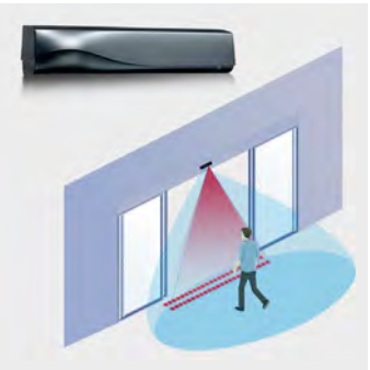
Sensore a doppia tecnologia (infrarossi + microonde) Questo sensore combina la tecnologia radar per l'attivazione della porta con la tecnologia a infrarossi per la sicurezza.
