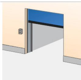
Un boîtier de commande supplémentaire est installé à l'extérieur du bâtiment ou à l'intérieur, près de la porte, pour le cas où la carte de commande principale devrait être installée loin de l'ouverture de la porte. Généralement combiné à une ouverture réduite. Installé sur le mur intérieur ou extérieur à côté de la porte.
