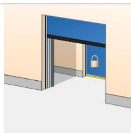
Développé pour la sécurité ou le contrôle de la température interne ; si la porte A est ouverte, la porte B ne peut pas l'être. Si la porte B est ouverte, la porte A ne peut pas l'être. Une porte verrouillée peut retenir une commande vers le haut, si celle-ci est sélectionnée via un contacteur. Eventuellement, un interrupteur verrouillé de l'extérieur peut être installé pour le désactiver.
