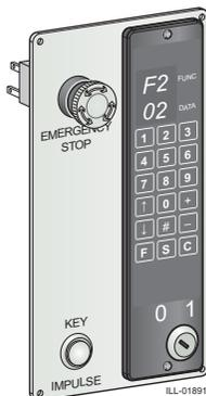
Le panneau de contrôle contient le PCD, une impulsion contact à clef et un bouton-poussoir d'arrêt d'urgence. L'impulsion contact à clef fait pivoter la porte de 360°. La distance maximale entre la porte et le PCD est de 100 m.
