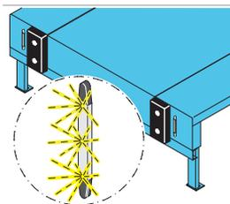
La luz de guía Dock-IN blanca de ASSA ABLOY consta de dos barras de luces LED blancas. Está diseñada para ayudar al camión en el proceso de acoplamiento. La luz de guía Dock-IN blanca de ASSA ABLOY ofrece mucha más ayuda visual que las franjas blancas en el abrigo o en el asfalto. Como se monta en la pared, siempre es claramente visible, está menos expuesta al desgaste y nunca queda cubierta por la suciedad o la nieve.
