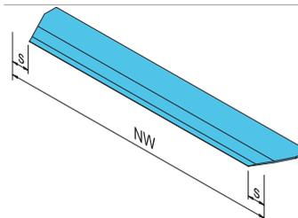
Un labio abatible con forma de trapecio garantiza que el labio llegará a la caja del camión, incluso cuando el camión no está aparcado exactamente en la posición central. Evita daños al camión e interrupciones en el procedimiento de acoplamiento.
