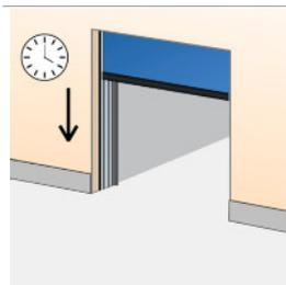
Un temporizador programable cierra la puerta al cabo del tiempo especificado, medido desde que se alcanza la posición de apertura completa y/o desde que se pasa por el haz de la fotocélula. Normalmente también se emplea un interruptor en la unidad de control para volver a cierre manual. Microinterruptores ajustables en cuadro de maniobras.
