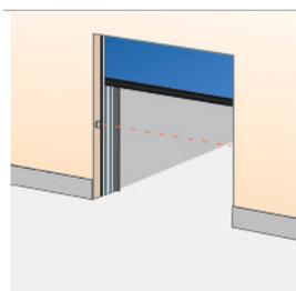
Un grupo de fotocélulas de transmisión y recepción que va montado en el hueco de la puerta. Si se interrumpe el haz de las fotocélulas durante el cierre, la puerta se detiene en menos de 30 mm y retrocede a la posición de apertura completa. Se instala en el hueco de la puerta a 300 mm sobre el nivel del suelo.
