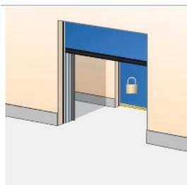
Desarrollado para climatización o seguridad; si la puerta A está abierta, la puerta B no se puede abrir. Si la puerta B está abierta, la puerta A no se puede abrir. Una puerta bloqueada puede recordar el comando de apertura si se selecciona a través de un microinterruptor. Opcionalmente, puede instalarse un interruptor exterior de bloqueo para su desactivación.
