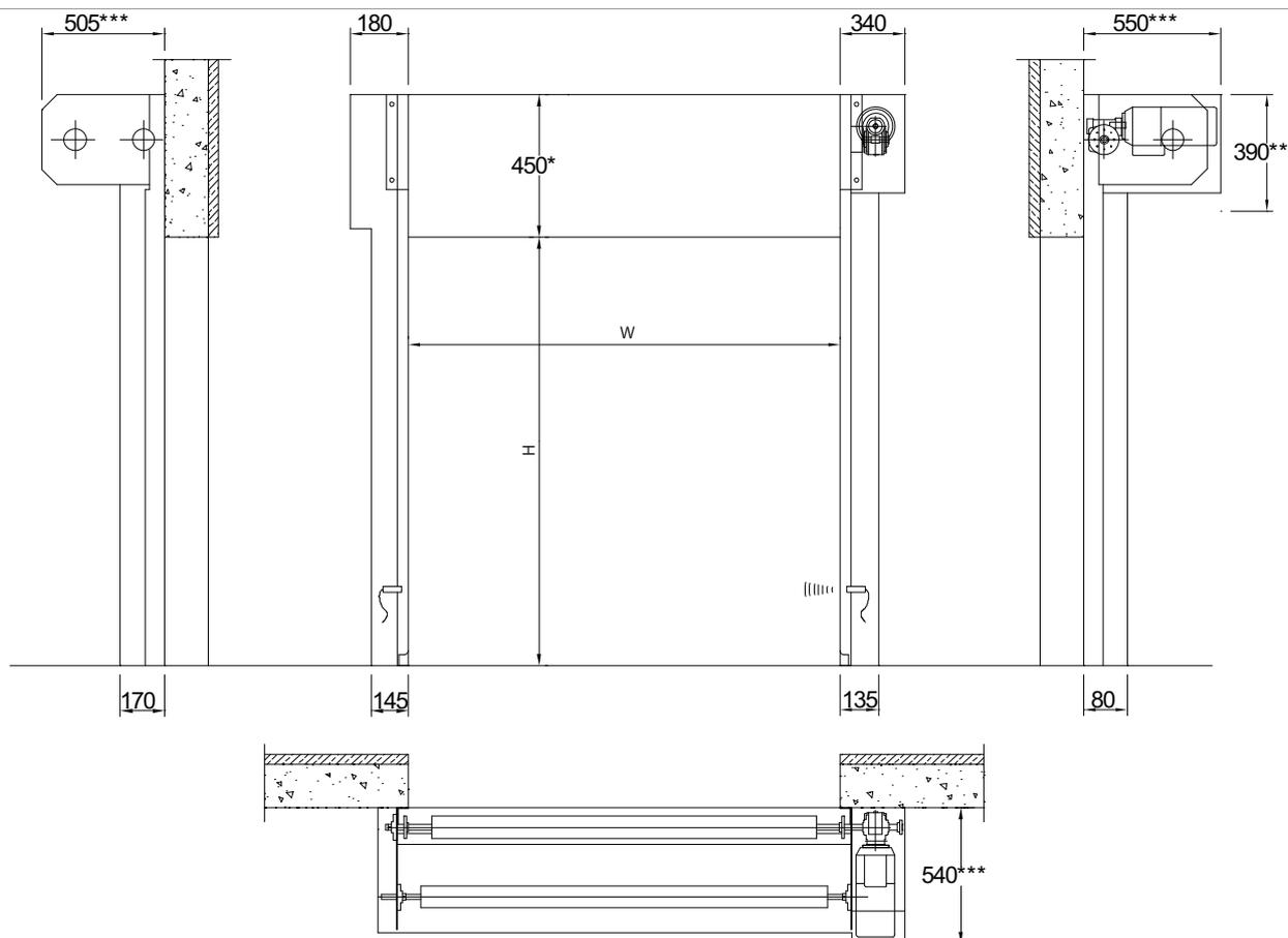
\* Si hay cubierta de cilindro y  $H > 4000$  mm = 650 mm
