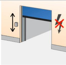
Es posible que en casos de emergencia o fallos de la alimentación principal, sea necesario abrir la puerta. La batería del sistema de alimentación ininterrumpida (SAI) almacena suficiente energía para un ciclo de apertura de emergencia.
