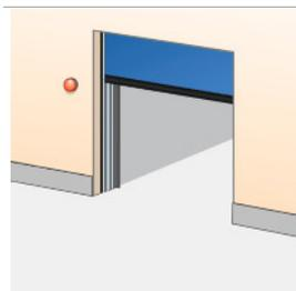
A cada lado hay una luz de aviso roja que informa del estado actual de la puerta. La luz parpadea antes y durante el movimiento de la puerta. Se instala en la pared interior y exterior, junto a la puerta.
