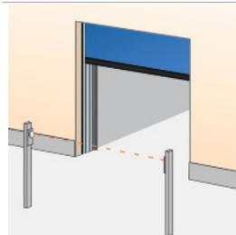
Un conjunto de fotocélulas instaladas en pilares, a cada lado de la puerta. Cuando una persona o vehículo pasa entre las fotocélulas, el haz se interrumpe y la puerta se abre. Fotocélulas instaladas en pilares, lejos de la puerta.
