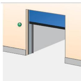
A cada lado hay una luz de aviso verde que informa de la posición de apertura de la puerta mediante una señal de luz continua.
