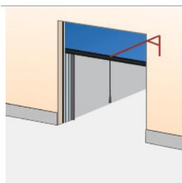
Un interruptor de tirador instalado encima del hueco de la puerta puede accionarse, por ejemplo, desde una carretilla elevadora. La puerta se abre cuando se tira de la cuerda. Se instala en el interior de la construcción, encima de la puerta.
