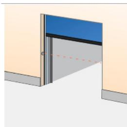
Un grupo de fotocélulas de transmisión y recepción que va montado en el hueco de la puerta. Si se interrumpe el haz de las fotocélulas durante el cierre, la puerta se detiene en menos de 30 mm e invierte el movimiento hasta que se encuentra en posición de apertura completa. Se instala en el hueco de la puerta a 300 mm sobre el nivel del suelo.
