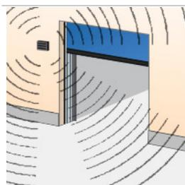
Se emite una señal acústica antes de que la puerta comience a cerrarse y se mantiene hasta que la puerta se ha cerrado por completo. Se instala en la pared interior y exterior, junto a la puerta.
