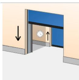
Desarrollado para control de climatización o seguridad: Excepto cuando se utiliza el interbloqueo, la puerta B se abre automáticamente cuando la puerta A se cierra. Tarjeta de circuito instalada en el cuadro de maniobras. Opcionalmente, puede instalarse un interruptor exterior de bloqueo para su desactivación.
