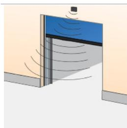
Un sensor de infrarrojos instalado encima de la puerta detecta objetos (personas o vehículos) dentro de una distancia determinada de la puerta y abre la puerta automáticamente. Esta es una solución ideal para lugares con tráfico frecuente de vehículos o personas. Suele combinarse con cierre automático.
