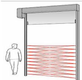
Todas las puertas están equipadas con una cortina de luz de seguridad. La cortina de luz es un dispositivo de seguridad que le permite evitar el contacto con una puerta que se cierra en todo su ancho y hasta 1,6 m de altura. La puerta invierte el movimiento si detecta cualquier obstrucción.
