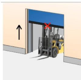
Todas las puertas están equipadas con un dispositivo de detección. El dispositivo inalámbrico de detección de la viga inferior blanda detecta obstrucciones cuando se cierra la puerta e invierte el movimiento.
