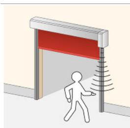
Es posible instalar un sensor de infrarrojos para abrir la puerta sin contacto y permitir el paso de personas. El sensor se puede colocar en el cobertor del motor o se puede utilizar un soporte alternativo para instalar el dispositivo en cualquier lugar. Se trata de una solución ideal en un entorno en el que, por motivos de higiene, las personas deben evitar tocar objetos.
