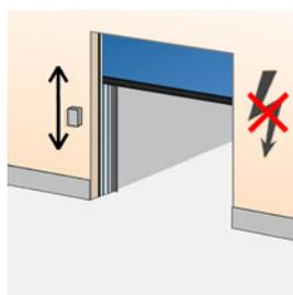
Es posible que en casos de emergencia o fallos de la alimentación principal, sea necesario abrir la puerta. La batería del sistema de alimentación ininterrumpida (SAI) almacena suficiente energía para un ciclo de apertura de emergencia. Se instala en la pared interior, al lado de la puerta.
