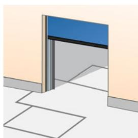
Un sensor instalado en el suelo abre automáticamente la puerta cuando detecta un objeto de metal (normalmente una carretilla elevadora o una transpaleta). Esta es una solución ideal para lugares con tráfico frecuente de vehículos. Se instala en el suelo en el exterior, interior o a ambos lados de la puerta.
