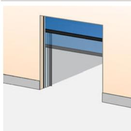
Para que la gente pase, tal vez no hay que abrir del todo una puerta. Con un comando manual (peatonal) se puede activar una apertura reducida de la puerta, mientras que con un radar o lazo magnético puede seguir abriéndose del todo. Microinterruptor premontado para activarse en la caja de control.
