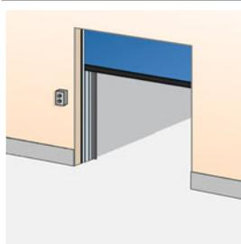
Cuando el cuadro de maniobras principal tiene que instalarse lejos del hueco de la puerta, se debe instalar un cuadro de maniobras adicional en el exterior del edificio, cerca de la puerta. Generalmente se combina con apertura reducida. Se instala en la pared interior o exterior, junto a la puerta.
