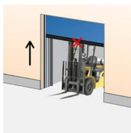
Todas las puertas están equipadas con un dispositivo de detección. La dispositivo de detección inalámbrico de la viga inferior blanda detecta obstrucciones mientras la puerta se cierra y cambia la dirección de la misma.
