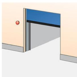
A cada lado hay una luz de aviso naranja que informa sobre el estado actual de la puerta. La luz parpadea antes y durante el movimiento de la puerta. Se instala en la pared interior y exterior, junto a la puerta.
