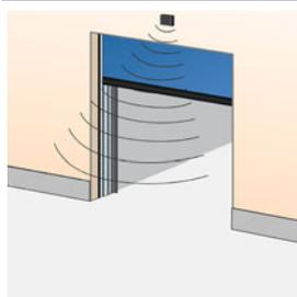
Un sensor de infrarrojos instalado encima de la puerta detecta objetos (personas o vehículos) dentro de una distancia determinada de la puerta y abre la puerta automáticamente. Esta es una solución ideal para lugares con tráfico frecuente de vehículos o personas. Suele combinarse con cierre automático. Se instala en la pared interior o exterior, encima de la puerta.
