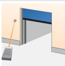
Un radiotransmisor manual permite controlar el funcionamiento de la puerta desde un vehículo o desde cualquier posición dentro de 50--100 metros del receptor y de la antena junto a la puerta. Para el cierre de la puerta, ésta se puede equipar con un haz de fotocélula. Receptor instalado en el cuadro de maniobras y antena instalada en la pared junto a la puerta.
