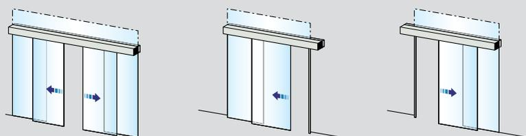
Montado sobre perfil autoportante, puertas y hojas fijas laterales (montaje fijo opcional)
