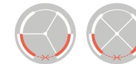
*Außenliegende Nachtverschlusstüren* sind ein zusätzlicher Satz Türen, der an der Außenseite der Trommelwand einer Karusselltür angebracht sind.
