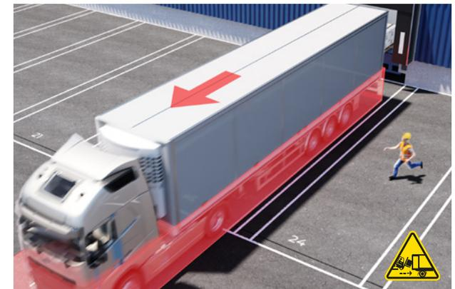
Se il carico o lo scarico di un veicolo non adeguatamente bloccato viene effettuato con un mezzo di sollevamento pesante, il veicolo può spostarsi lentamente in avanti ogni volta che il mezzo di sollevamento entra ed esce dal veicolo stesso.
