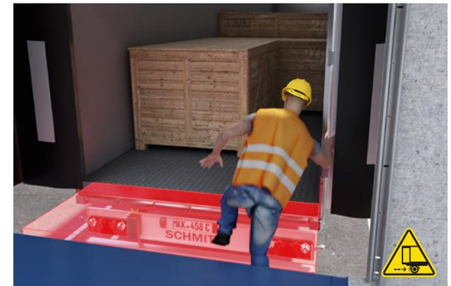
Un varco che si apre tra un veicolo attraccato e la baia di carico può passare inosservato, spesso causato dallo spostamento di un carico e dall'improvviso movimento in avanti del veicolo.
