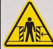
**Nicht ordnungsgemäß gesicherte Fahrzeuge können unbemerkt rückwärts rollen und jeden einklemmen, der sich zwischen dem Fahrzeug und der Überladebrücke aufhält.**
