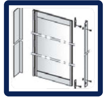
Klapp- bzw. schiebbare Schutzflügel zur Absicherung von Gefahrenstellen
